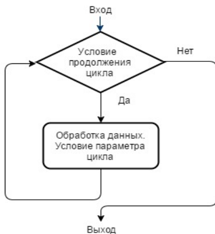
Рис. 1.4. Блок-схема циклического алгоритма
