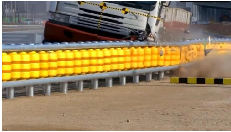
Рисунок 2 – Краш-тест барьерного ограждения Road Roller System (вид сбоку)
