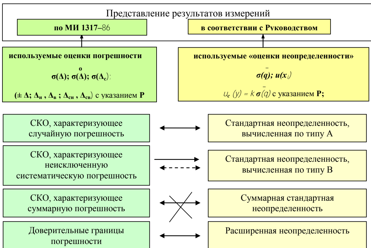
"Схема соответствия" оценок характеристик неопределенностей и погрешностей по РМГ 43
