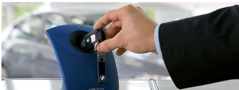
Рисунок 9 – Процесс считывания данных при помощи «КиРидер» с ключа автомобиля
