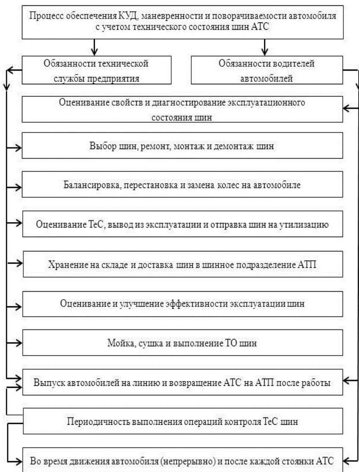
Рисунок 2 – Структурная схема, на которой показаны шинные работы АТП, направленные на повышение безопасности движения автомобилей
