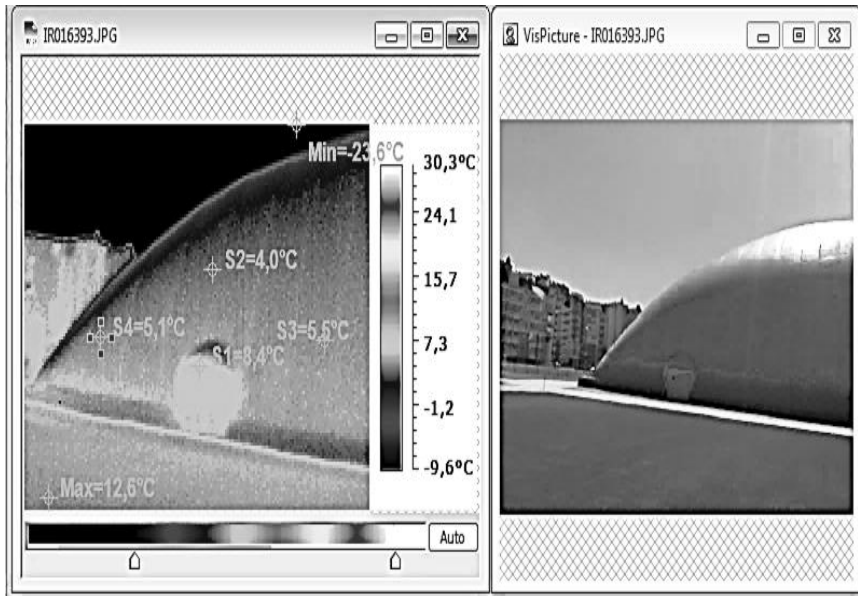
Рис. 2. Термограмма и фотосъемка наружной поверхности оболочки объекта
