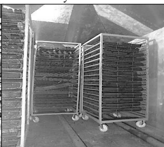
Рис. 8. Вид контейнера с сформованным топливом в стационарной сушилке
