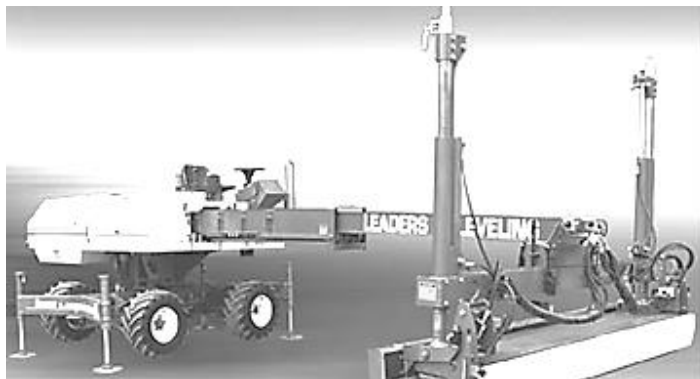
Рис. 1. Автоматическое оборудование с лазером для выравнивания бетона (LaserScreed)
