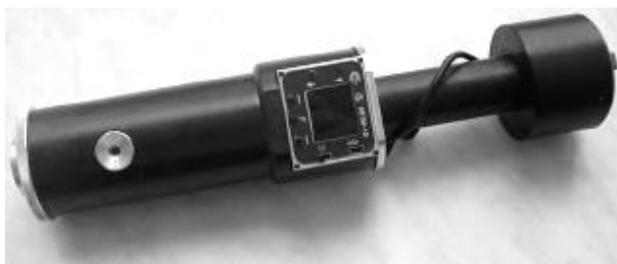
Рис. 2. Внешний вид прибора ИПМ-1Б
