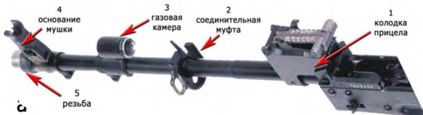
Рис. 1.10. Наружная часть ствола автомата (пулемета): 1 – колодка прицела; 2 – соединительная муфта; 3 – газовая камера; 4 – основание мушки; 5 – резьба для навинчивания ДТК
