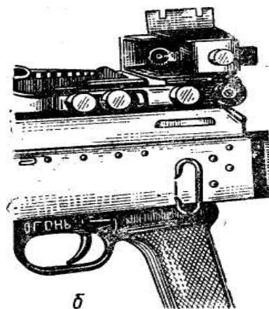
Рис. 3.3. Ортоскоп диоптрийный к открытым прицелам
