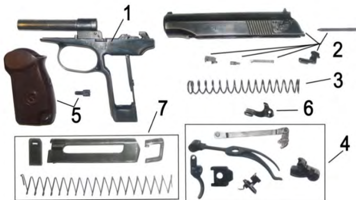
Рис. 1.23. Основные части пистолета:
