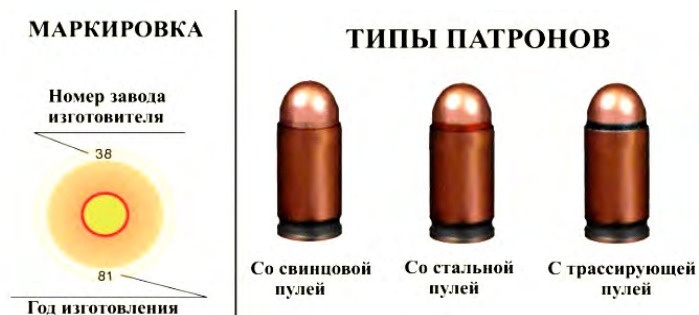
Рис. 1.22. Типы и маркировка 9-мм патронов к пистолету
