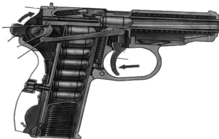
Рис. 1.24. Работа частей и механизмов пистолета при выстреле
