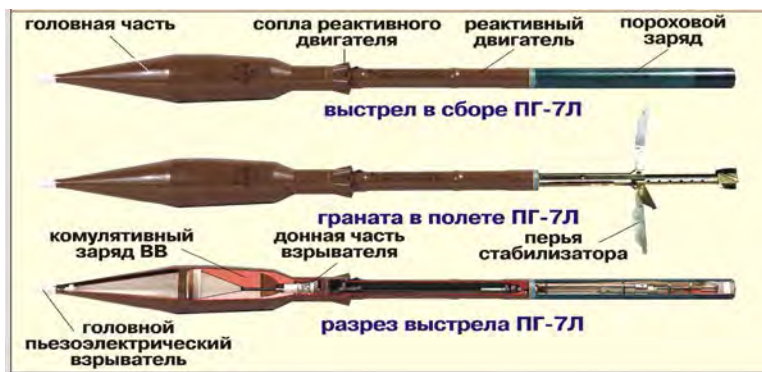
Рис. 1.39. Выстрел ПГ-7Л и его устройство
