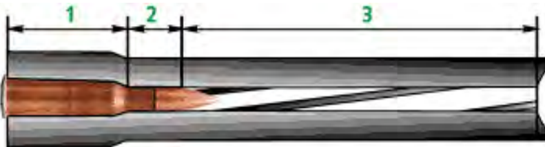
Рис. 1.9. Внутренняя часть ствола автомата (пулемета): 1 – патронник; 2 – пульный вход; 3 – нарезная часть
