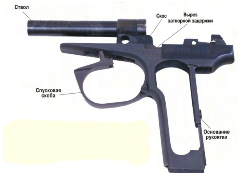
Рис. 1.26. Устройство рамки со стволом и спусковой скобой
