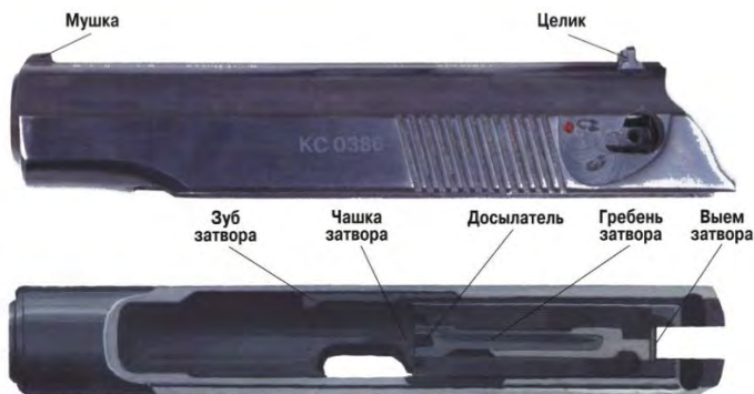
Рис. 1.27. Устройство затвора 9-мм пистолета ПМ
