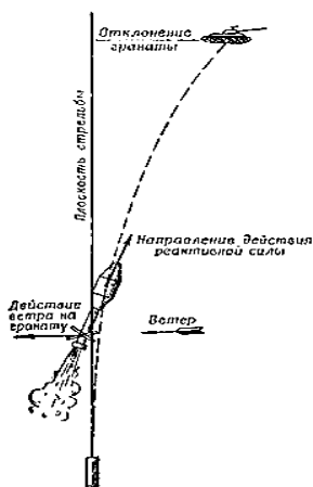
Рис. 1.43. Отклонение реактивной гранаты при боковом ветре
