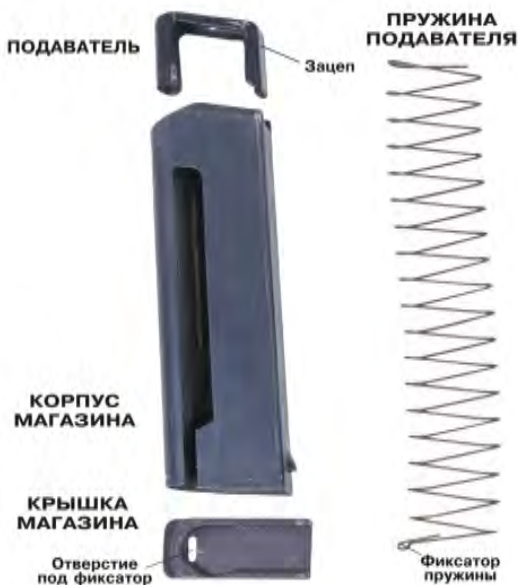
Рис. 1.35. Устройство магазина пистолета ПМ
