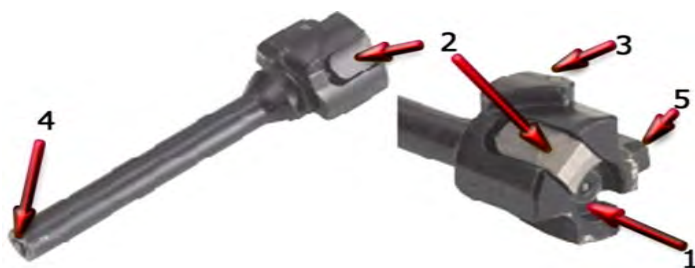
Рис. 1.16. Устройство затвора: 1 – вырез для гильзы; 2 – выбрасыватель; 3 – ведущий выступ; 4 – ударник; 5 – боевой выступ
