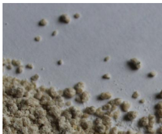
Рисунок 2 – Алюмосиликатная шихта с микросферами оксида алюминия
