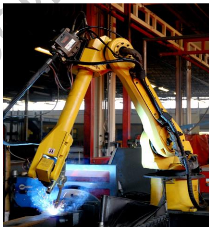
Рисунок 7 – Роботизированный сварочный пост
