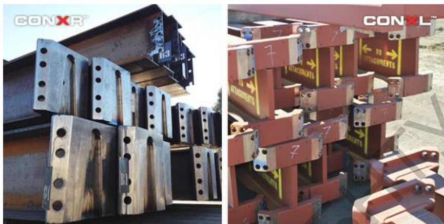
Рисунок 3 – Опорные части балок систем ConXL и ConXR
