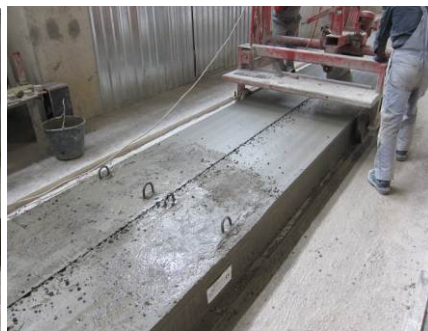
Рисунок 3. Технология изготовления плит безпалубочного формирования
