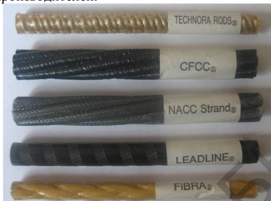
Рисунок 1. Внешний вид композитной арматуры зарубежных производителей
