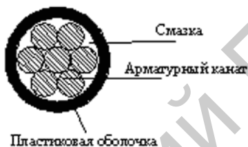
Рисунок 2. Сечение каната в оболочке
