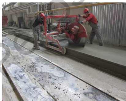
Рисунок 3. Технология изготовления плит безпалубочного формирования
