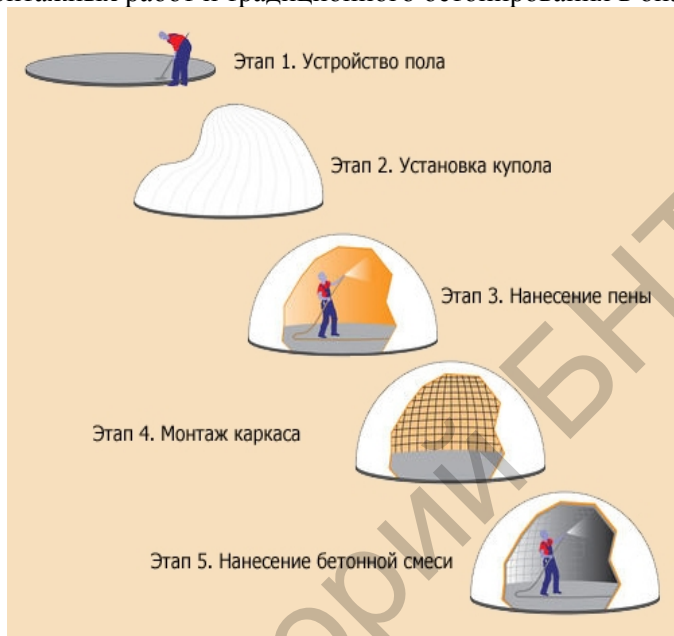
Рисунок 1. Этапы возведения купольного сооружения
