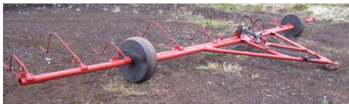
Рис. 2. Ворошилка для ворочки кускового торфа.
