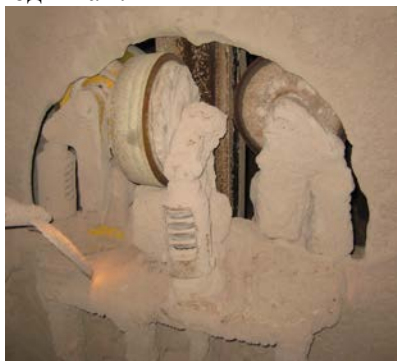
Рис. 1. Роликовые направляющие с пружинным амортизатором с резиновой ограничительной вставкой
