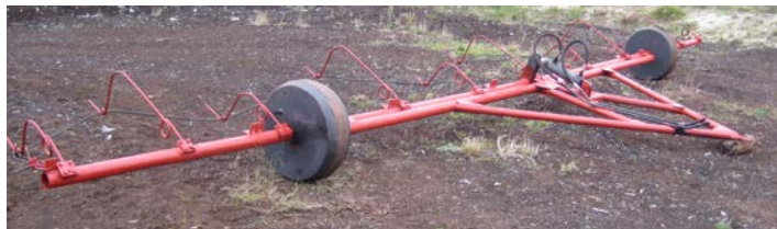
Рис. 2. Ворошилка для ворочки кускового торфа.
