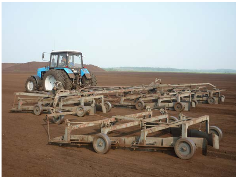
Рис. 1 Машинно-тракторный агрегат в составе (МТЗ-1025) + (МТФ-33Б)
