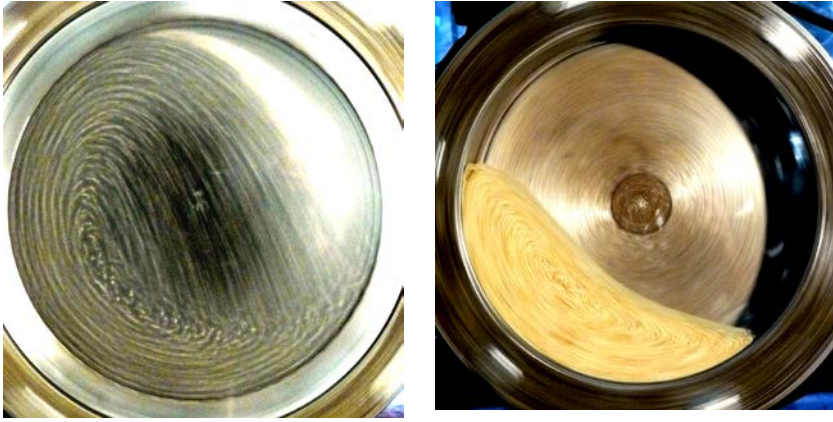
Рис. 3. Картины движения загрузки при двухстадийном измельчении: а – предварительный грубый помол, б – окончательный тонкий помол.
