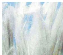
Хризотил-асбест – это волокнистый минерал группы серпентинита и амфибола, обладающий трубчатым строением элементарного кристалла и высокими прочностными и термическими свойствами.
