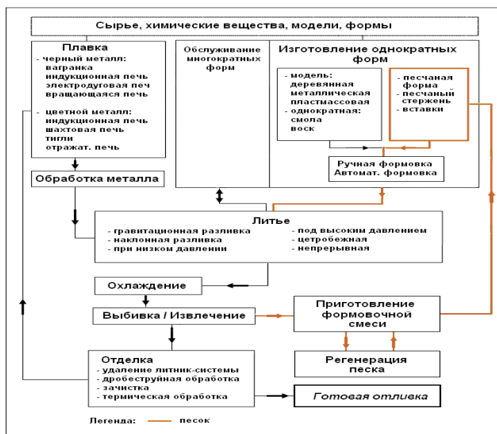
Рисунок 1 – Общая схема литейного процесса
