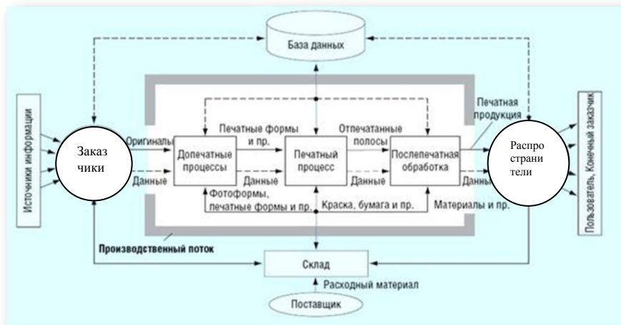
Рисунок 1 – Схема производственных процессов на полиграфическом предприятии
