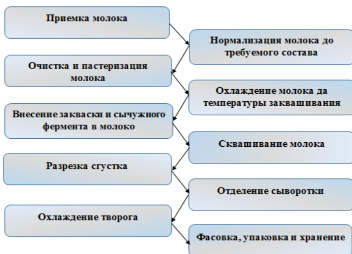
Рисунок 1 – Этапы производства творога кислотным способом
