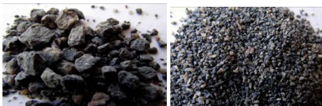
Рисунок 1 – Порошок гранита: а) поставляемый производителем, б) рассеянный фракции 200–600 мкм
