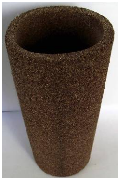
Рисунок 2 – Образец ППИ на основе гранита
