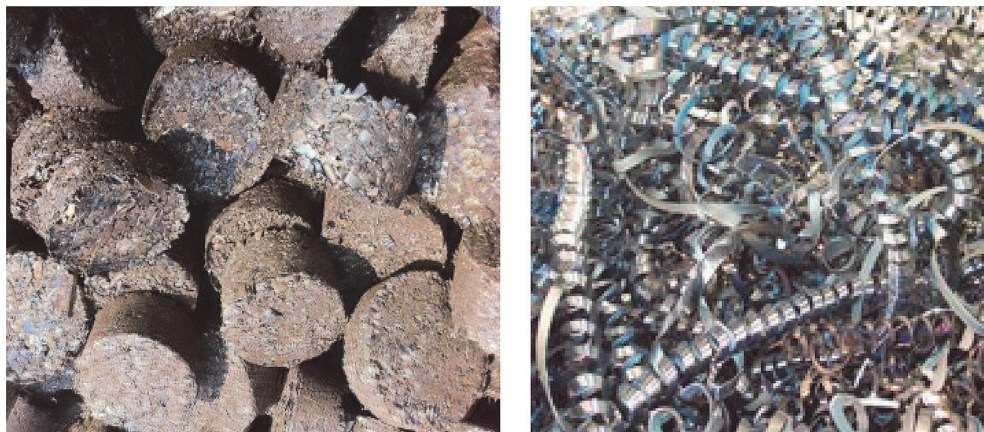
Рис. 1. Стружка черных металлов: а – брикетированная; б – вьюнообразная
