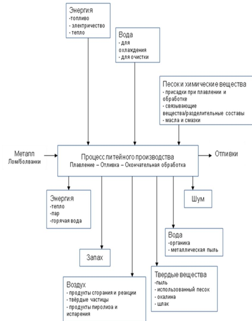
Рисунок 2 – Обзор массовых потоков для процесса литейного производства
