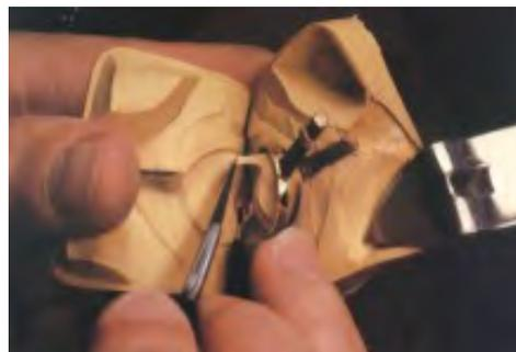
Рисунок 9.2 - Приспособление для разжатия резиновой пресс-формы
