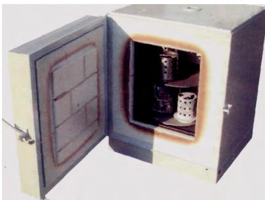
**Рисунок 11. 2 - Муфельная печь для обжига опок**
