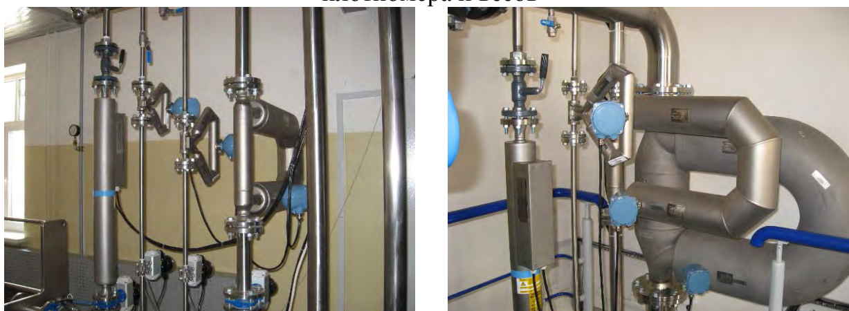
Рисунок 3.16 Массовые расходомеры CMF, плотномер Solartron 7835
