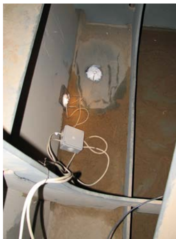
Рис. 6. Датчики контроля внутренних механических напряжений, установленные в контрольном сечении
