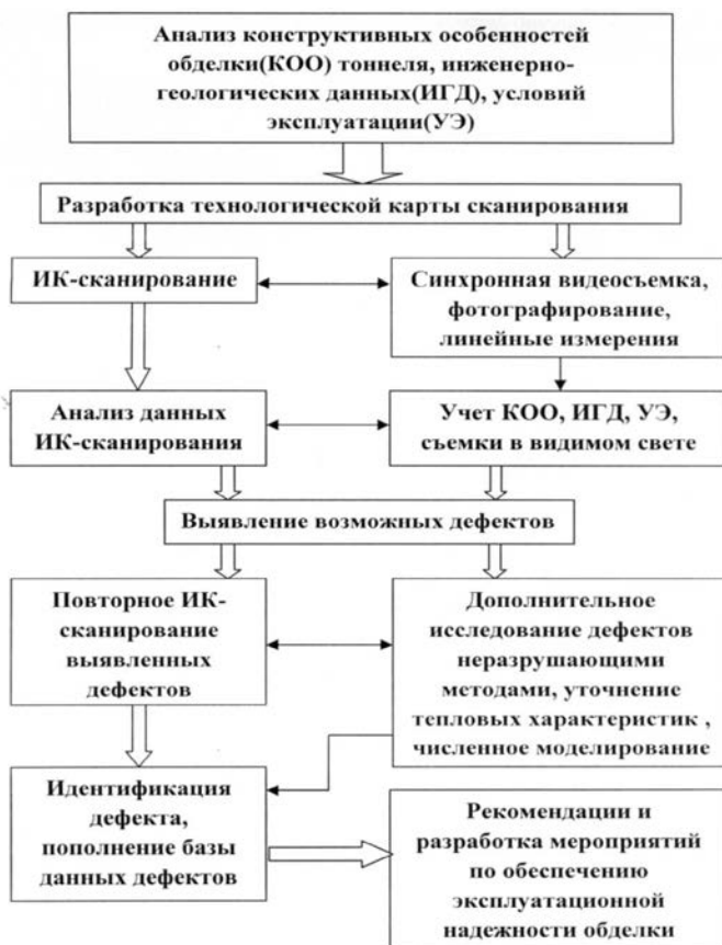
Рис. 1. Блок-схема ИК-сканирования обделки тоннеля
