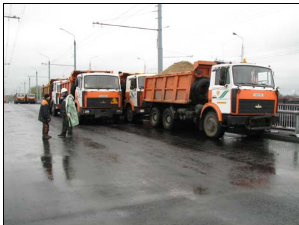
Рис. 8. Установка испытательной нагрузки для основного загрузения Выводы по результатам научно-технического сопровождения строительства моста
