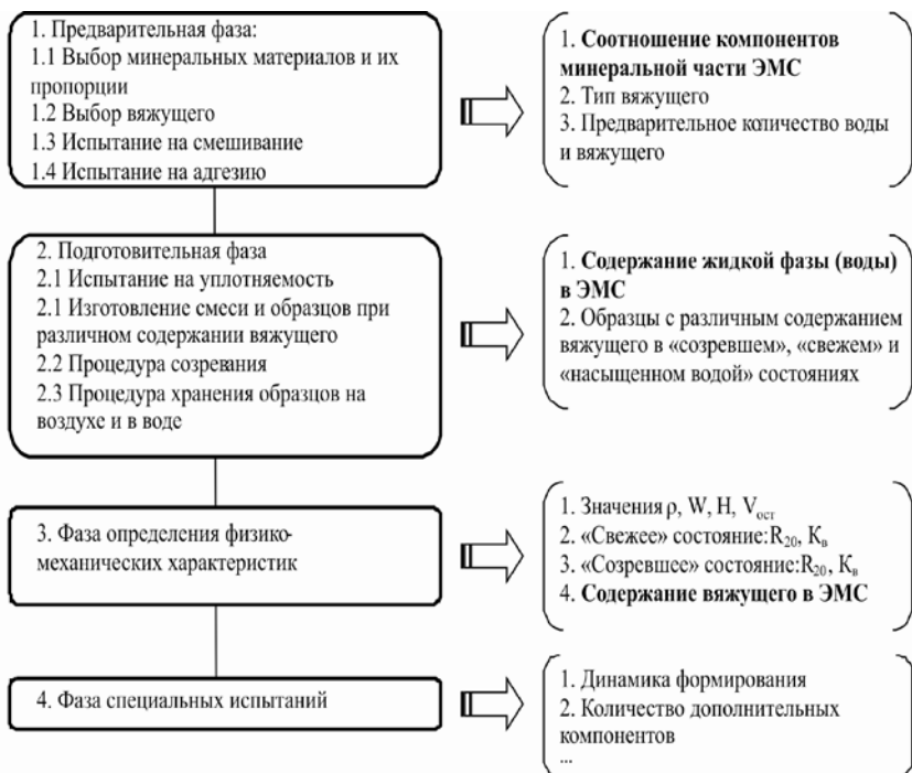
Рис. 1. Блок-схема предлагаемой методики подбора состава ЭМС
