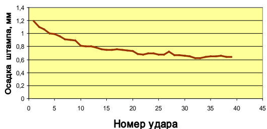
Рис. 1. Зависимость осадки штампа от количества ударов падающего груза
