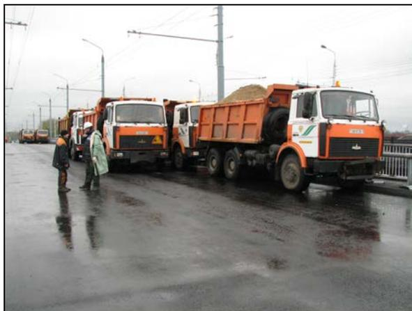
Рис. 8. Установка испытательной нагрузки для основного загрузения
