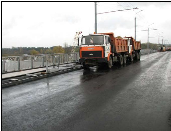
Рис. 7. Установка испытательной нагрузки для линий влияния
