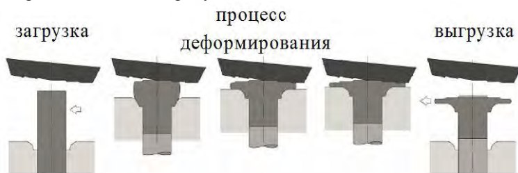
Рисунок 1 – Циклы СШ конического зубчатого колеса
