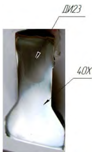
Рис. 1 - Фото продольного шлифа биметаллической детали типа «Выталкиватель»
