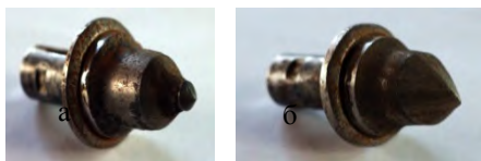
Рис. 1 - Фото резцов после испытаний: а) резец из стали 5ХНМ и наконечником из ВК20; б) резец из стали Д12З и наконечником из стали Р18
