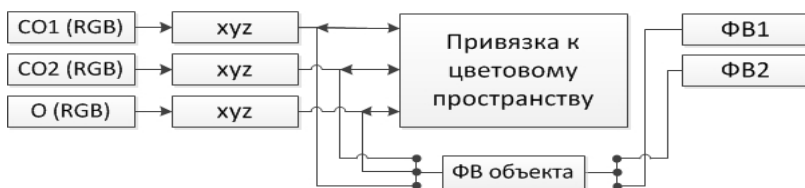
Рисунок 1 – Функциональная схема программного продукта «Фотон»
