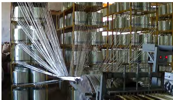
Рисунок 1 – Общий вид станка по производству канатной арматуры Научный руководитель - Ляхевич Г.Д.
