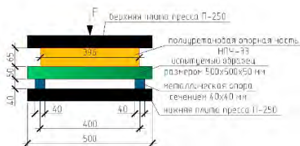
Рисунок 1 – Схема испытания натурных образцов
