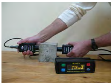
Рисунок 1 – Определение прочности бетона неразрушающим методом
