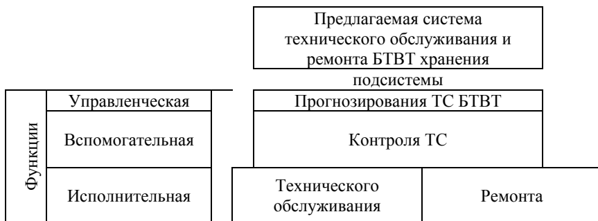
Рисунок 1 – Структура предлагаемой системы технического обслуживания с периодическим контролем и ремонтом по техническому состоянию образцов БТВТ, находящихся на хранении
