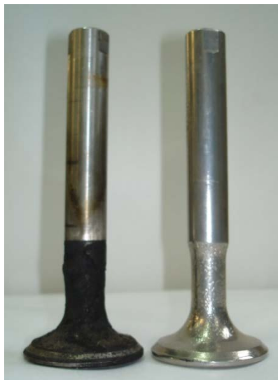
Рисунок 1 – Внешний вид клапана ДВС до (слева) и после ЭИП (справа)
