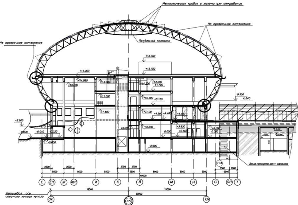
Рисунок 2 – Разрез здания Штаб-квартиры по оси F/1
