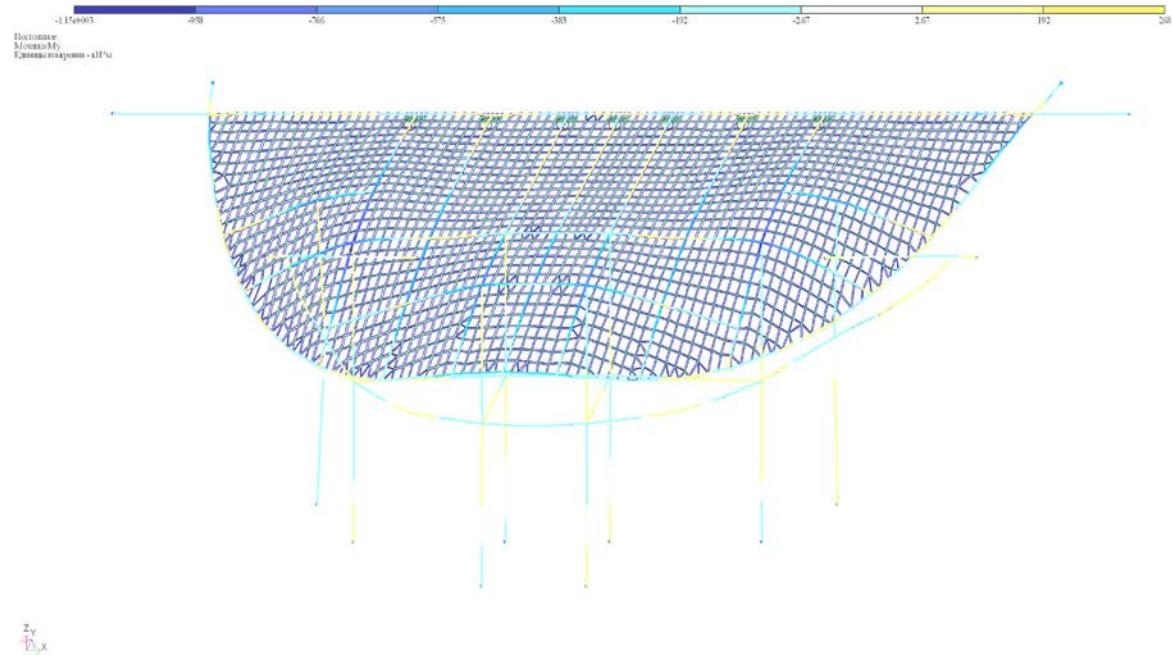
Рисунок 4 – Деформированная схема балочного перекрытия
