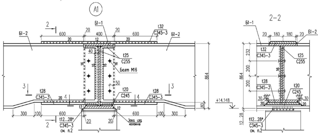
Рисунок 3 – Монтажные узлы сопряжения элементов балочного перекрытия
