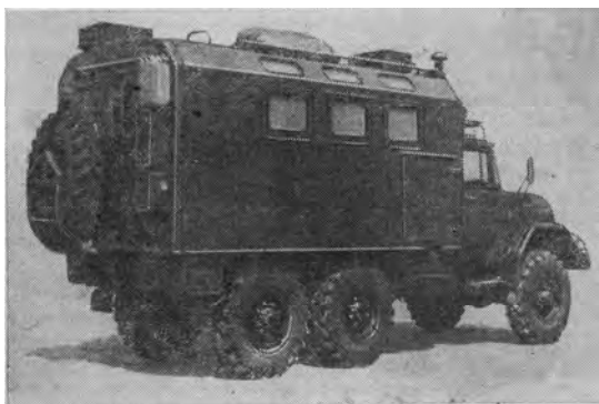
Рис. 2.1 Унифицированный кузов-фургон типа КМ131
