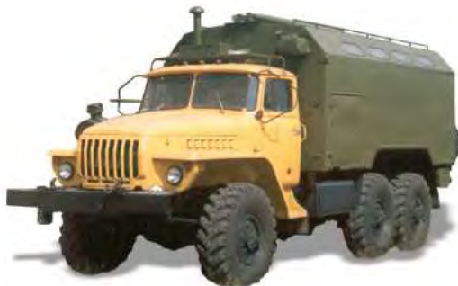
Рис. 3.4 Мастерская ремонта электрооборудования МРЭ-АМ1
