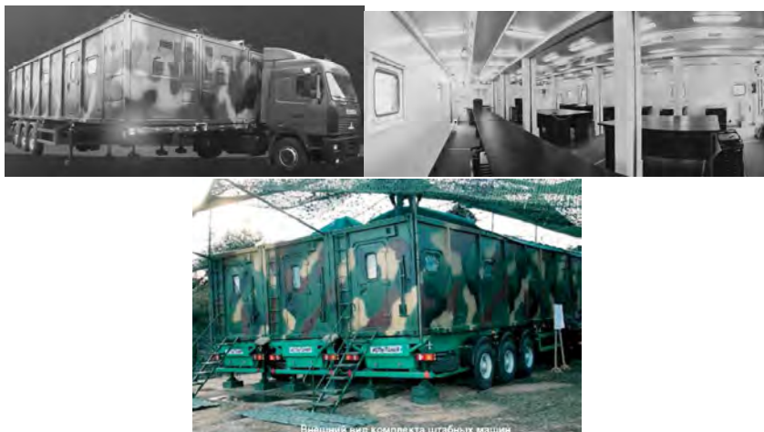
Рис. 3.45 Комплект машин штабных модульных (Модуль)
