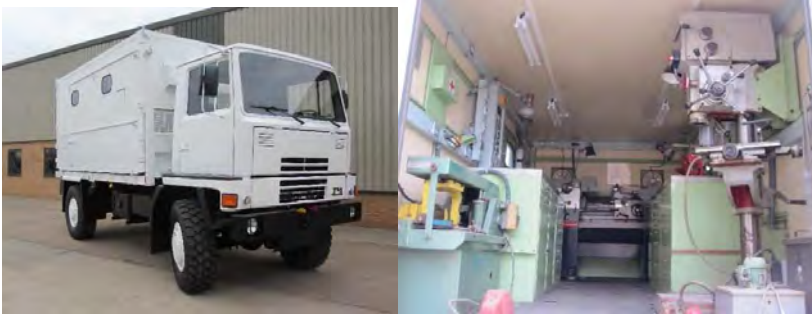
Рис. 3.29 Передвижная авторемонтная мастерская универсального назначения Bedford TM 4×4 ПАРМ
