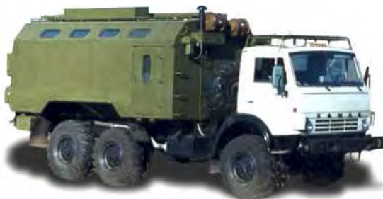
Рис. 3.2 Мастерская ремонтно-слесарная MPC-AMP
