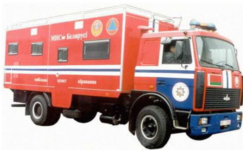
Рис. 3.36 Специальный автофургон КУПАВА модель ПП6324 на шасси МАЗ 533603
