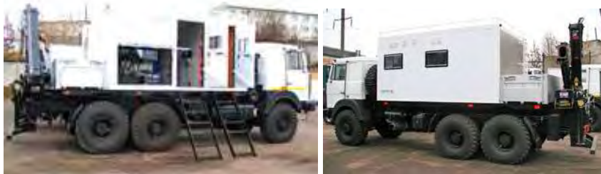
Рис. 3.38 Передвижная аварийно-ремонтная мастерская с крановым манипулятором на базе шасси МАЗ 631705-370
