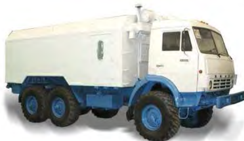
Рис. 3.6 Мастерская ремонта приборов системы питания топливом МРП-А
