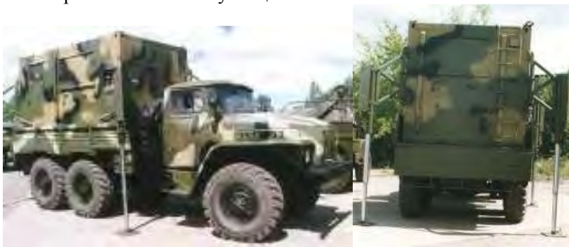
Рис. 4.2 Легкосъемные унифицированные кузова-контейнеры
