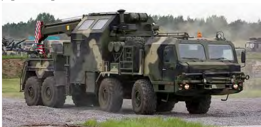
Рис. 3.12 Машина ремонтно-эвакуационная колесная средняя РЭМ-КС
