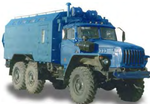
Рис. 3.3 Мастерская ремонтно-механическая МРМ-М3.1
