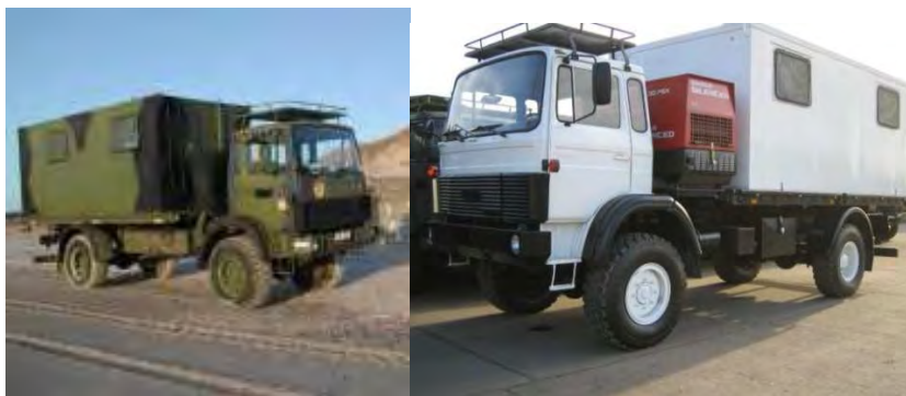
Рис. 3.30 Iveco Magirus 110 4×4 ПАРМ+АРС автомастерская
