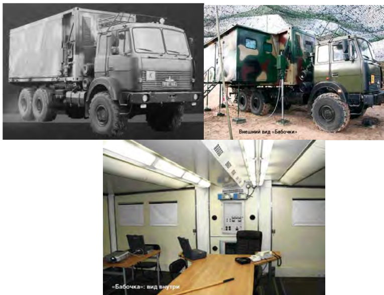
Рис. 3.44 Машина для командования и штаба с кузовом-контейнером переменного объема «Бабочка»
