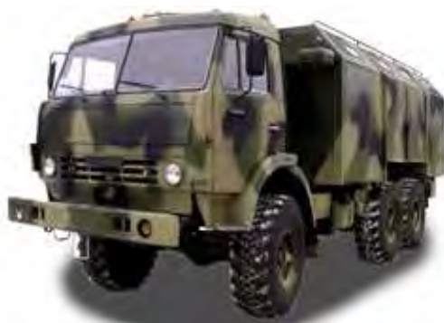
Рис. 3.5 Мастерской ремонта электрооборудования МРЭ-А
