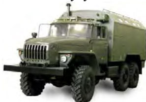
Рис. 3.8 Мастерская сварочных работ МСР
