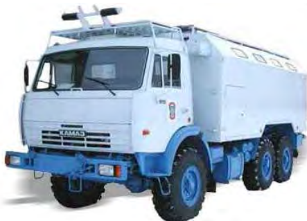
Рис. 3.1 Мастерская технического обслуживания МТО-АМ
