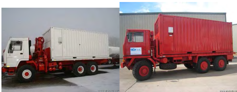
Рис. 3.31 Передвижная авторемонтная мастерская на шасси IVECO BEDFORD MERCEDES-BENZ MAN с КМУ (слева) и без него (справа)
