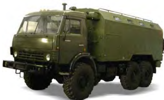
Рис. 3.7 Мастерская заряда и ремонта аккумуляторов МЗА
