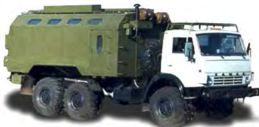
Рис. 1.6 Мастерская МТО-АМ на шасси автомобиля КамАЗ-43101
