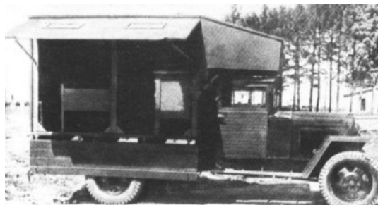
Рис.1.2 Походные автомобильные ремонтные мастерские типа Б на шасси автомобиля ЗиС-5 или ЗиС-6
