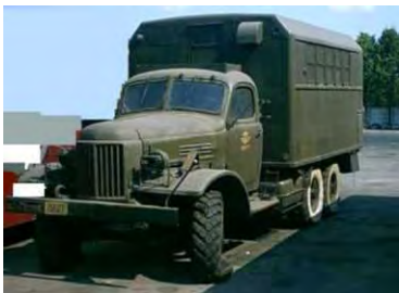
Рис. 1.3 Передвижная мастерская на шасси автомобиля ЗИЛ-157(ЗИЛ-157К)
