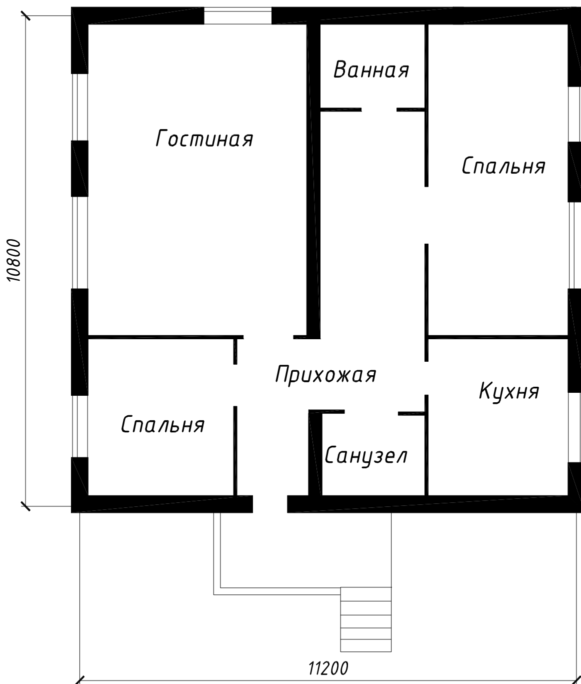
Рис. 8.4. Одноэтажный многоквартирный трехкомнатный жилой дом (вариант 2)
