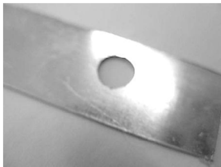
Рис. 8.11. Фотография образца с полученным путем электрохимической обработки отверстием
