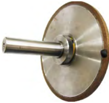
Рис. 6.14. Фотография круга с искусственно созданной неуравновешенностью
