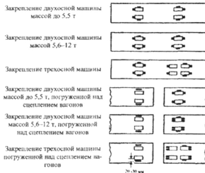
**Рисунок 3** – Схема типовых упорных и боковых брусков при закреплении на платформах колёсных машин
