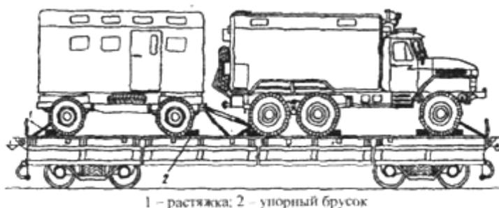
**Рисунок 2** – Закрепление трехосного автомобиля и двухосного прицепа с помощью растяжек и упорных брусков
