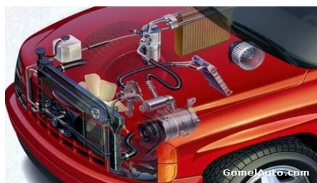
Рис. 1. Основные элементы автомобильной климатической системы
