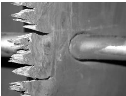
Рисунок 1 – Эрозия рабочих лопаток последних ступеней
