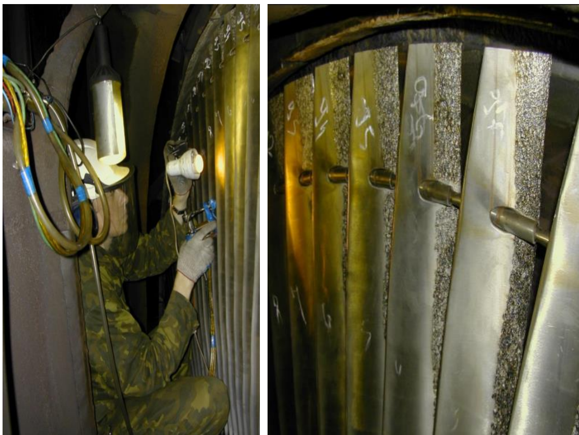
Рисунок 5 – Формирование покрытия через конденсатор на входных кромках РЛ 5-й ступени турбины К-300-240 ХТГЗ и внешний вид сформированного покрытия сплава ВК60М
