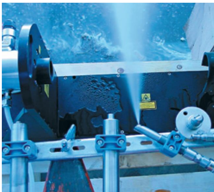
Рисунок 1 – Категоризация размеров капель форсунки лазерным анемометром
