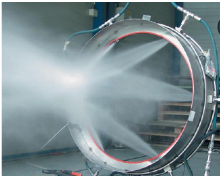
Рисунок 3 – Периферическое размещение форсунок
