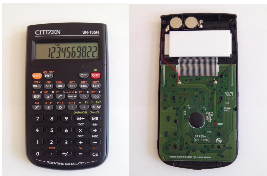
Рисунок 1 – Виды спереди и сзади со снятой крышкой калькулятора CITIZEN SR-135N
