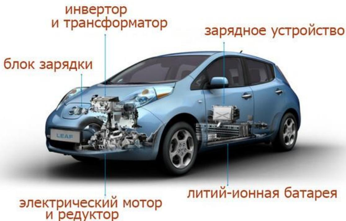
Тяговая аккумуляторная батарея обеспечивает питание электродвигателя. На электрических автомобилях, в основном, используются литий-ионная аккумуляторная батарея, которая состоит из ряда соединенных последовательно модулей. На выходе аккумуляторной батареи снимается напряжение постоянного тока порядка 300В.
