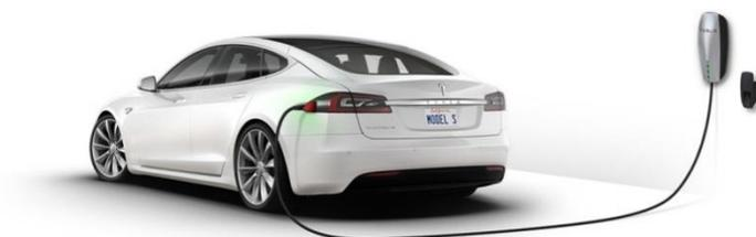
В данный электрокар установлен современный литий-ионный аккумулятор имеющий емкость 85 кВт\*ч или 60 кВт\*ч (зависит от комплектации). Этого аккумулятора хватает, чтобы преодолеть расстояние равное 426 км и 335 км соответственно. Батарея состоит из 16 блоков и располагается вдоль днища автомобиля, что дополнительно повышает торсионную жесткость и безопасность.
