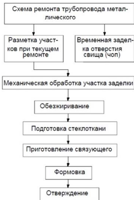
Рис. 6.1. Последовательность операций при ремонте трубопровода стеклопластиком
