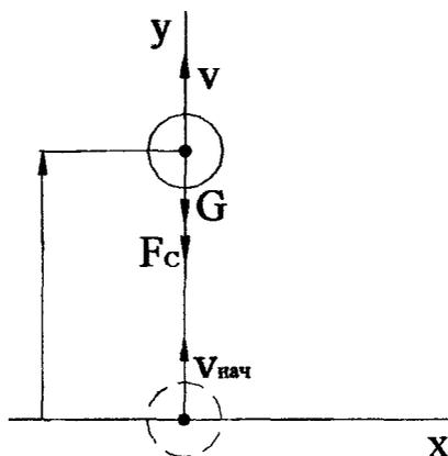
Рис. 3.5. Расчетная схема для определения характеристик движения тела, брошенного вертикально вверх
