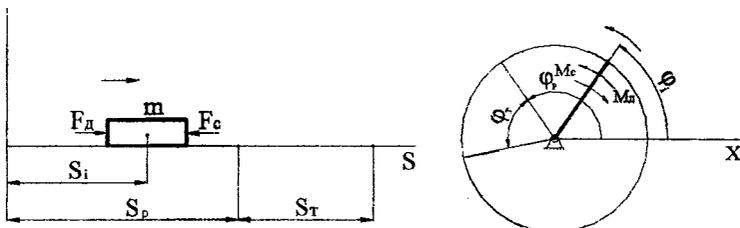
Рис. 3.1. Расчетная схема для определения параметров движения при поступательном и вращательном движениях
