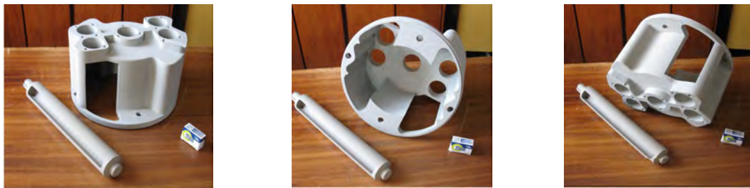
Рисунок 6 - Керамикоподобное покрытие на поверхности алюминиевых комплектующих расходомера
