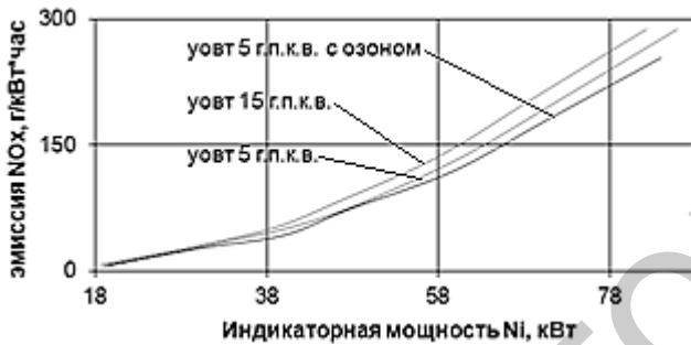
Рисунок 4 – Моделирование эмиссии - NOx при увеличении нагрузки дизеля
