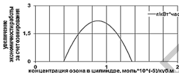
Рисунок 8 – Моделирование эффективности применения озонирования воздушного заряда
