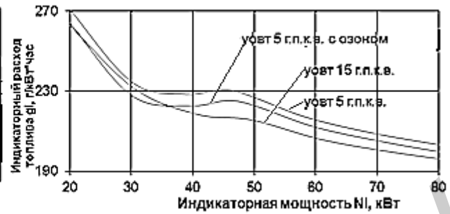
Рисунок 3 – Моделирование удельного индикаторного расхода топлива
