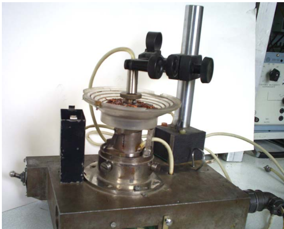
Рисунок 1.14 – Вибробункер с системой контроля амплитуды колебаний чаши.
