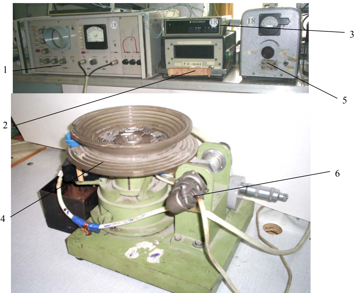
Рисунок 1.12 – Установка для исследования работы вибрационного бункерного загрузочного устройства:
