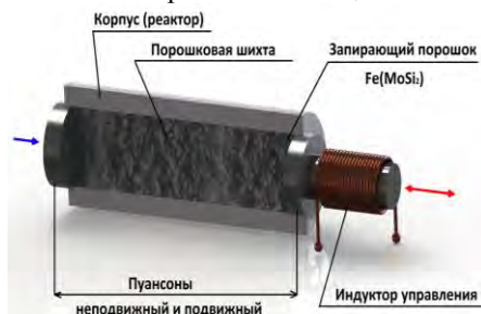
Схема модели для проведения реакционного спекания
