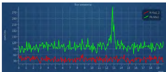
Рисунок 2. Анализ стального образца свинцом и азотом по глубине.
