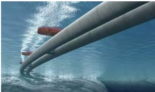
Рис. 1 – Подводные мосты в виде двух туннелей
