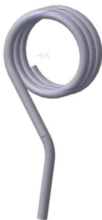
**Рисунок 1 – Пружинный зуб роторной почвообрабатывающей машины**
