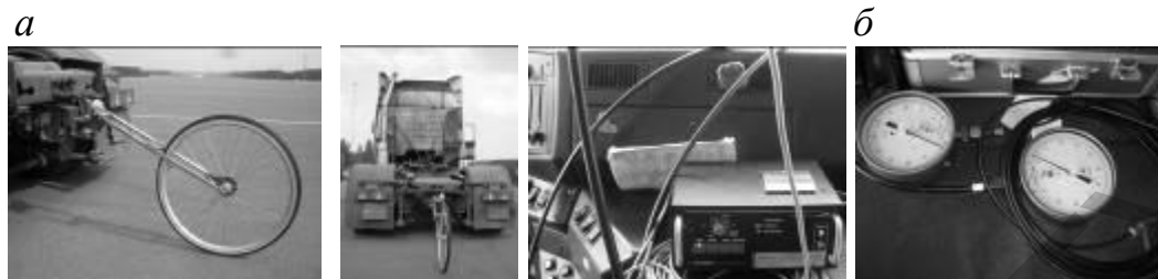
a – "пятое" колесо и регистратор "Peiseler"; б – манометры Рисунок 6 – Измерительное оборудование и приборы
